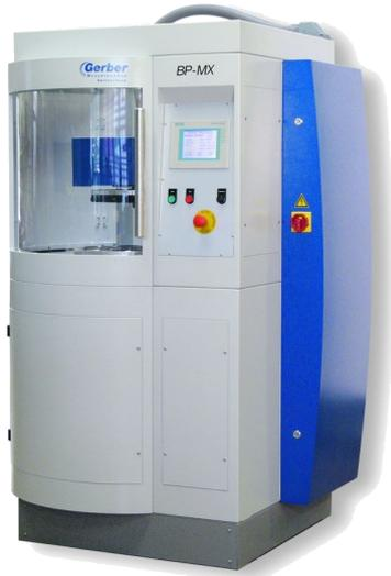
Das Handling der BP-MX durch Touchpanel ist schnell, einfach und perfekt kontrollierbar. Mit dem wechselbaren Revolver- oder Planetentisch für Rotationsteile ist die Maschine mit modularer Bauweise in anwenderspezifischer Konfiguration erhältlich. Es stehen Tische mit festen oder schwenkbaren Spindeln und mit zylindrischen oder HSK-Aufnahmen zur Verfügung.
