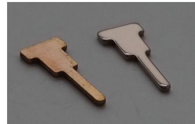
Abbildung 2: Entgraten und Polieren mit Mikro-Fliehkraft Schleifen
