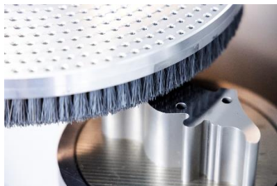
Abbildung 4: Mikroradien erhöhen die Lebensdauer von Werkzeugen
