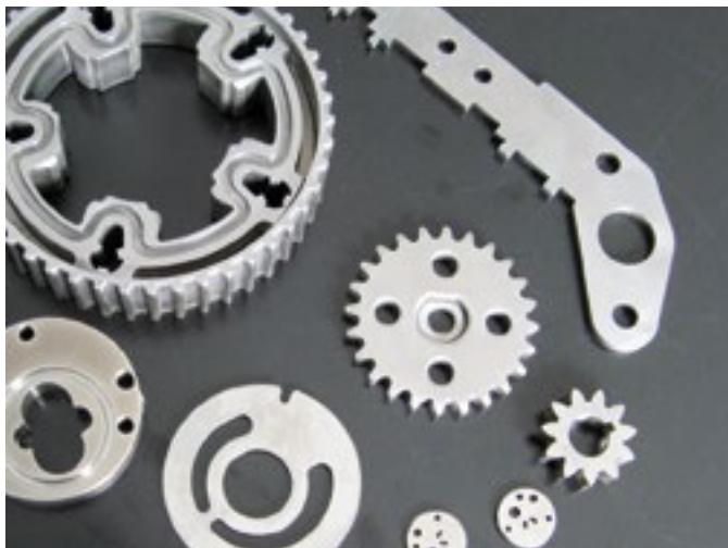
Typische Teile für das Bürstentgraten.
